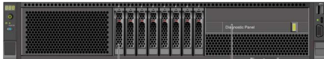
Sem armazenamento, suporta 8x SSDs/HDDs 2,5"
